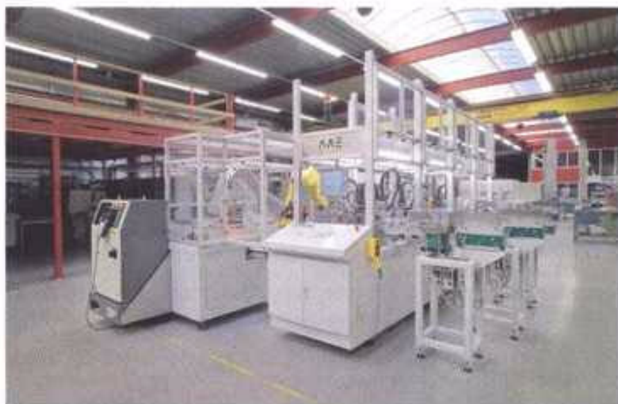
Bild 1. Während im Inneren der Anlage die Bauteile in Montagestationen zusammengesetzt werden, befindet sich das Handling der Teile im Außenbereich
